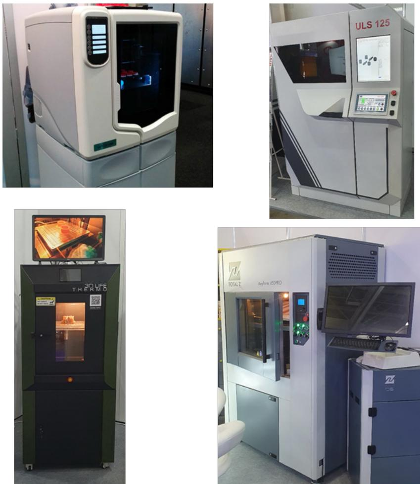
Рис. 4.18. Принтеры с термокамерами
