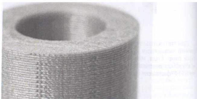
Рис. 5.5. Явно заметные линии слоев на напечатанных методом FFF/FDM-экструзии деталях
