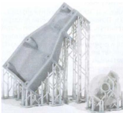
Рис. 6.11. Детали, напечатанные на SLA-принтере, печатающем снизу вверх, с прикрепленными поддержками
