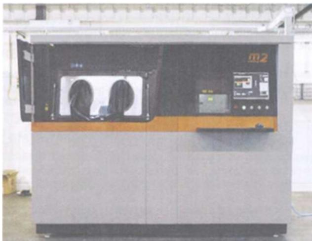
Рис. 10.7. DMLS-принтер Concept Laser M2
