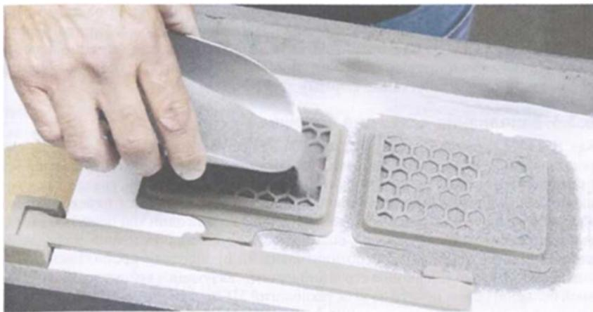
Рис. 9.5. Изделия из нержавеющей стали, покрываемые порошком для пропитки. Бронзовая пропитка показана слева
