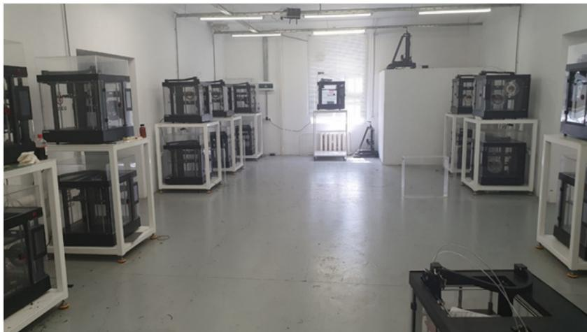
Рис. 5.12. Высокотехнологичные настольные принтеры с термокамерой и двойной экструзией в компании ООО «АТ 2050» используются для промышленного производства
