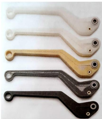
Рис. 5.19. Нейлоновые прототипы тормозных рычагов, изготовленные при помощи 3D-печати на принтере Markforged с разными типами материалов укрепления. Сверху вниз: нейлон без укрепления, укрепленный стеклопластиком нейлон, укрепленный кевларом нейлон, укрепленный углеродным волокном нейлон и укрепленная углеродным волокном деталь из филамента Onyx
