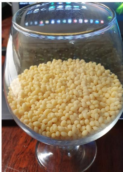
Рис. 4.27. Гранулы термопластического полиуретана, который часто используется при 3D-печати
