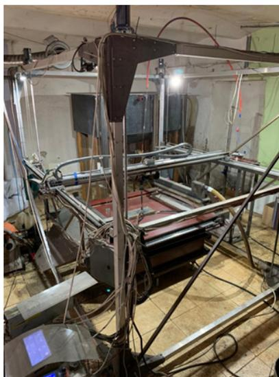
Рис. 10.12. Опытный образец WAAM-принтера
