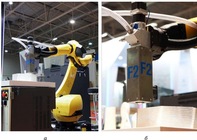
Рис. 4.25. Печать объемной детали 3D-принтером со шнековым экструдером, которой полностью управляет робот: *а* – общий вид устройства; *б* – шнековый экструдер и сопло, через которое продавливается расплавленный полимер
