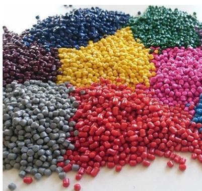
Рис. 4.26. Разноцветные гранулы различных полимеров для 3D-печати на 3D-принтере со шнековым экструдером
