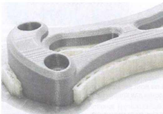
Рис. 5.7. FFF/FDM-деталь, напечатанная из PLA-пластика (серая), демонстрирующая растворимую PVA-поддержку (белая)
