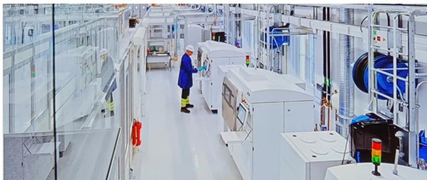
Рис. 5.13. Промышленные FDM-принтеры Siemens
