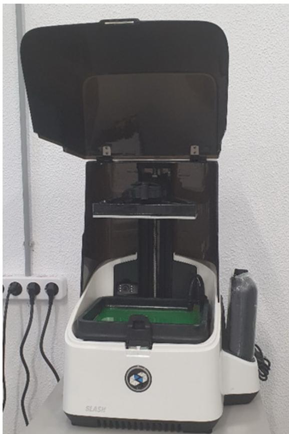
Рис. 6.5. 3D-принтер для полимеризации полимера в резервуаре, источником света в котором является LCD-дисплей. Печатает деталь сверху вниз
