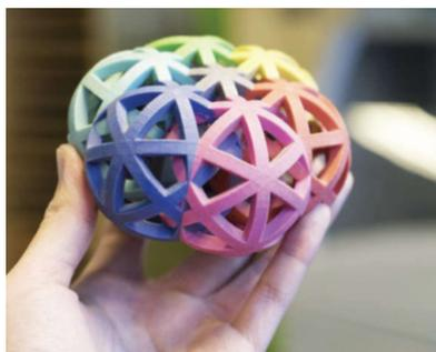
Рис. 9.4. Полноцветный отпечаток, изготовленный с применением песчаника для струйной печати связующим материалом
