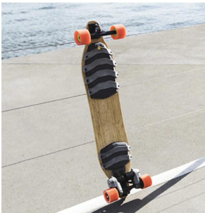
Рис. 7.9. Скобы и корпус двигателя на электрическом скейтборде, напечатанные на принтере HP 304200
