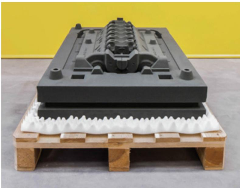
Рис. 9.7. Сборка песчаной формы из нескольких элементов для литья автомобильного блока цилиндров
