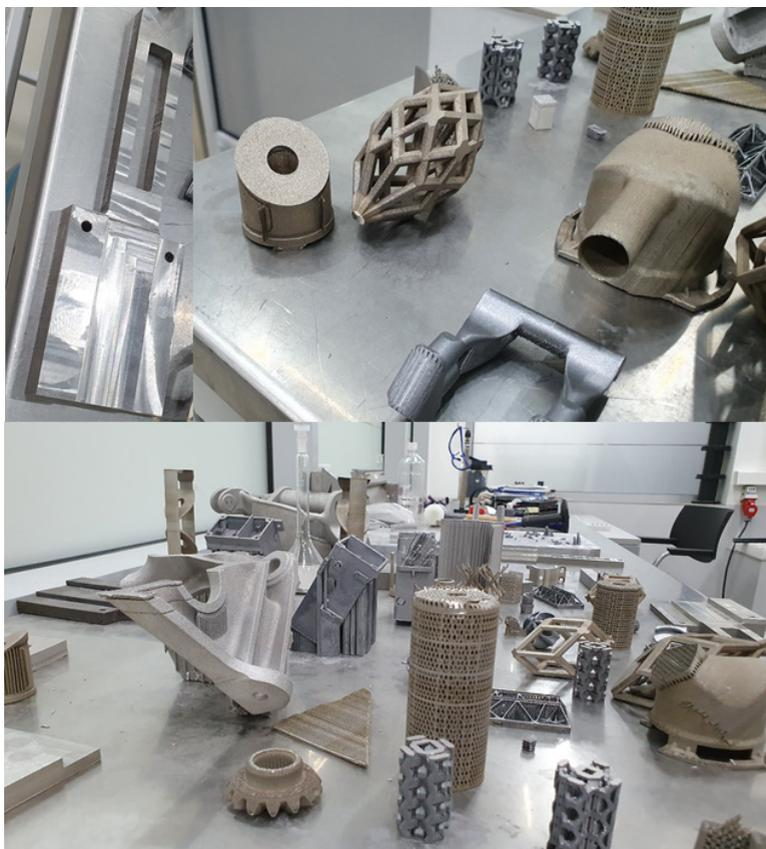
Рис. 10.9. Металлические детали, напечатанные из порошков различных металлов на 3D-принтере SLM 280 2.0
