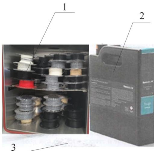
Рис. 3.10. Виды пластика для 3D-печати: 1 – катушки филамента для FFF; 2 – контейнер смолы для SLA; 3 – нейлоновый порошок для SLS
