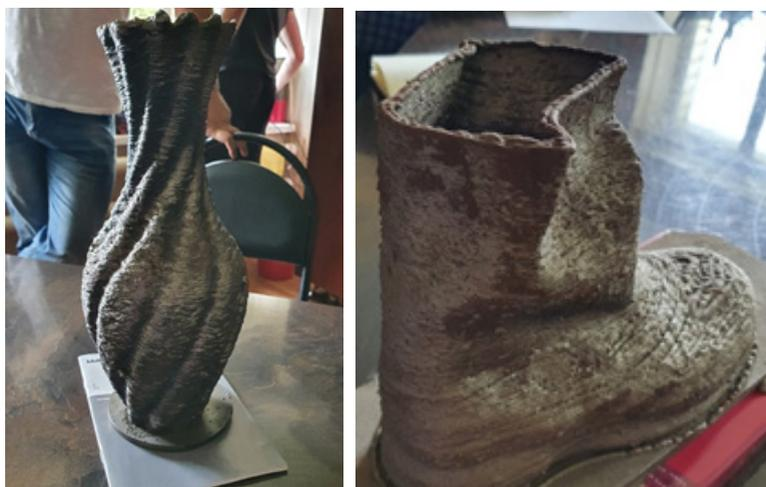
Рис. 10.13. Небольшие модели, напечатанные на опытном WAAM-принтере. Модели представлены без постобработки
