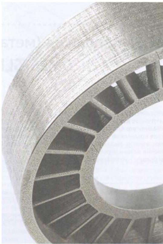
Рис. 9.8. Статор насоса для нефти и газа, напечатанный из нержавеющей стали и пропитанный бронзой
