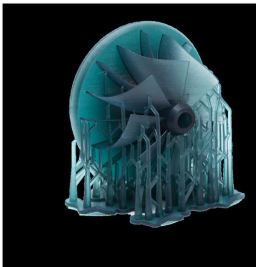
Рис. 6.9. Завершенная модель, напечатанная из прозрачной смолы, со все еще прикрепленными поддержками
